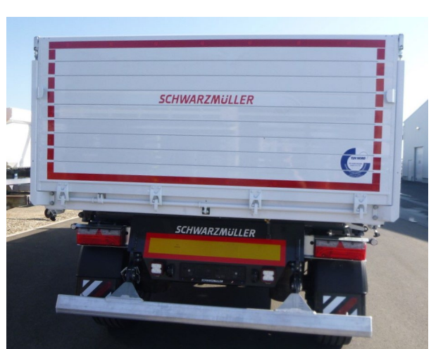
Ściana tylna z możliwością odchylenia: Wszystkie zamontowane elementy ruchome, takie jak zawiasy, zamki, sworznie, trzpienie itd. sprawdzić pod kątem zużycia i poprawności działania
