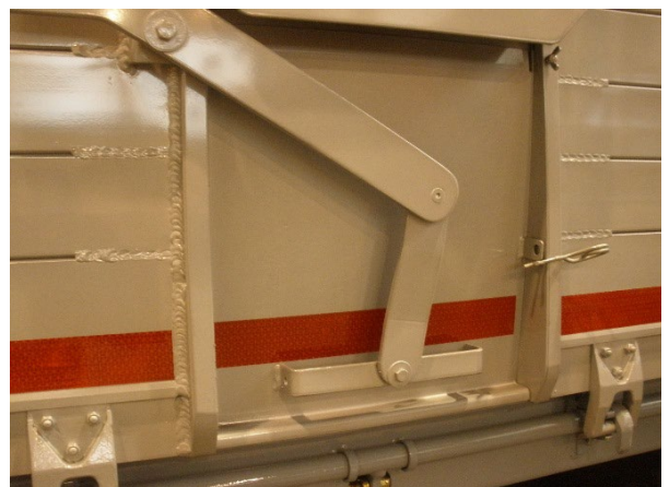
Tylna ściana: sprawdzić spoiny pod kątem pęknięć
