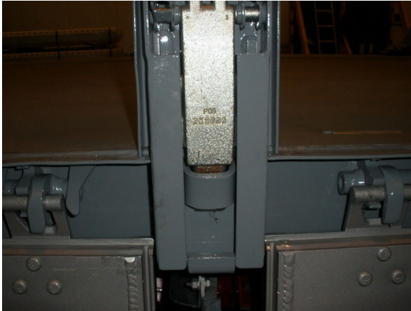
Uchwyty kłonic: sprawdzić spoiny pod kątem pęknięć, sprawdzić ruchome elementy pod kątem zużycia
