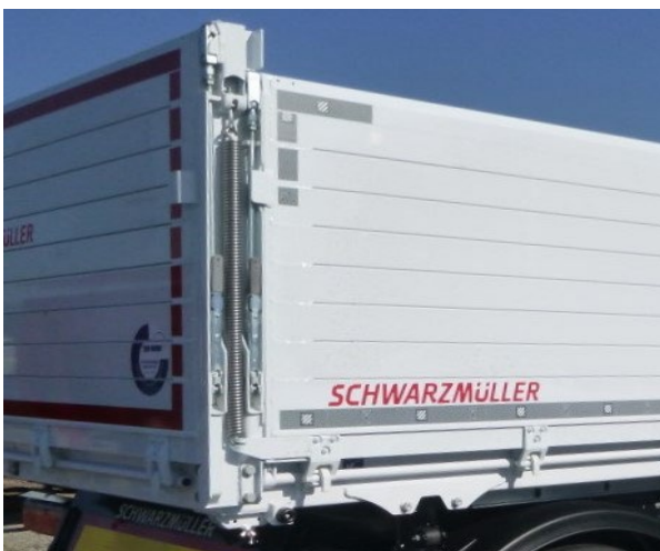
Ściana tylna z możliwością odchylenia: Wszystkie zamontowane elementy ruchome, takie jak zawiasy, zamki, sworznie, trzpienie itd. sprawdzić pod kątem zużycia i poprawności działania
