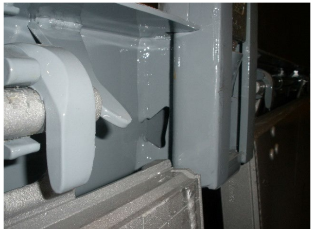
Uchwyt kłonicy: sprawdzić spoiny pod kątem pęknięć
