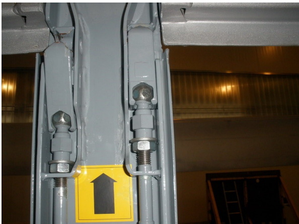
Sworzeń wahadłowy blokady sprawdzić pod kątem luzu i poprawności działania
