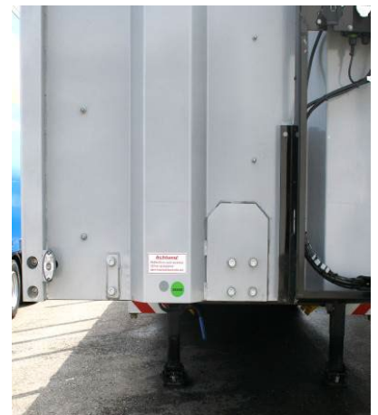
Ściana przednia na dole: sprawdzić trzymanie łączy na śruby
