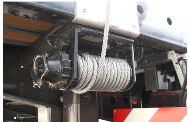
Roleki z liną naciągową: sprawdzić pod kątem poprawności działania i mocowania
