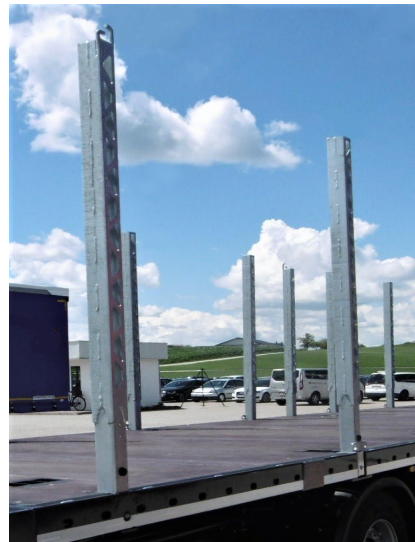
Wszystkie kłonicie i ich uchwyty: sprawdzić spoiny pod kątem pęknięć
