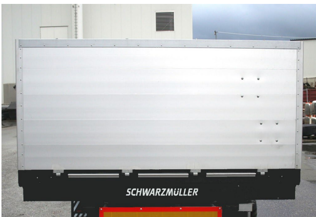
Ściana tylna: sprawdzić trzymanie nitów
