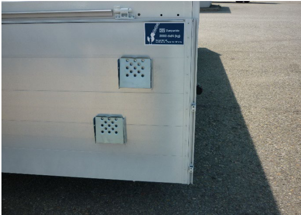
Ściana tylna: sprawdzić trzymanie nitów
