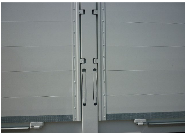
Środkowy słupek i słupki narożne (z przodu i z tyłu): sprawdzić poprawność działania blokady
