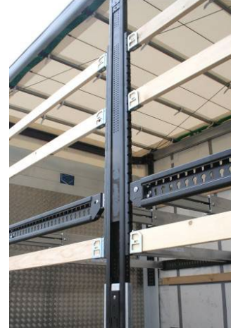
Środkowy słupek: sprawdzić mocowanie kieszeni na deski
