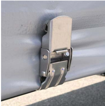
Bezpośredni napinacz plandeki: sprawdzić trzymanie nitów
