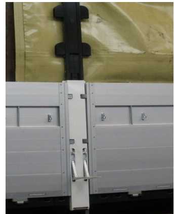
Burty: sprawdzić trzymanie nitów, sprawdzić trzymanie zamków
