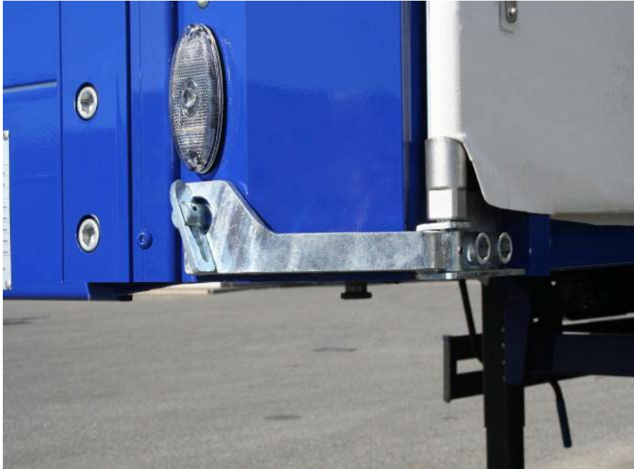
System szybkiego zamykania z przodu: sprawdzić mocowanie, poprawność działania, sprawdzić adapter drążka naciągu plandeki pod kątem uszkodzeń
