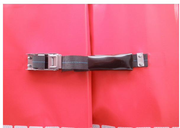
Pionowa zakładka plandeki: sprawdzić napinacze pod kątem uszkodzeń i prawidłowego działania
