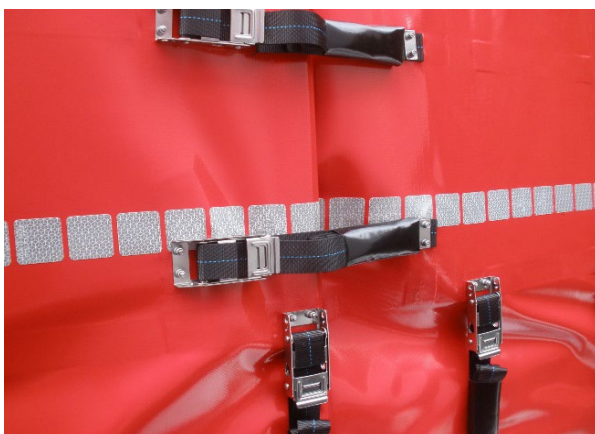
Pionowa zakładka plandeki: sprawdzić napinacze pod kątem uszkodzeń i prawidłowego działania
