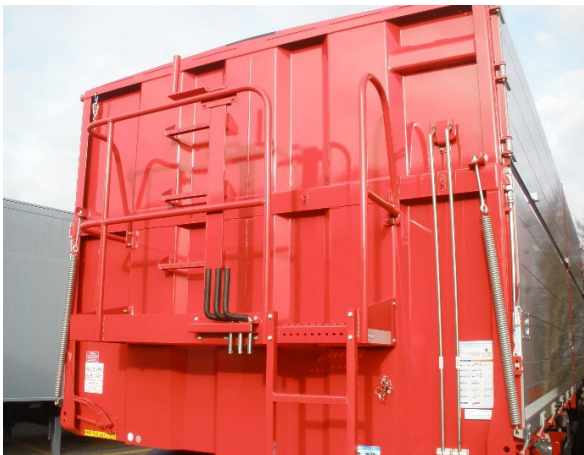
Minden hegesztési varrat ellenőrzése, van-e repedés. Zárak, zsanérok stb.: állapot vizsgálata szemrevételezéssel
