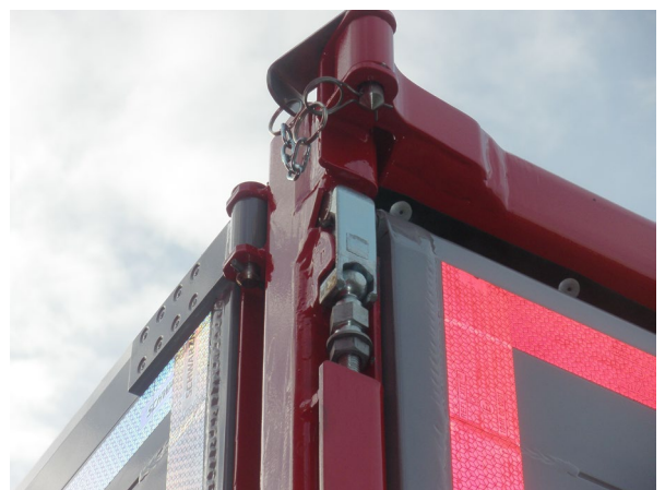
Zárszerkezet: kopottság és megfelelő működés ellenőrzése
