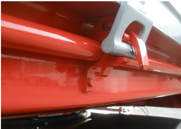
Központi zár: szemrevételezéses vizsgálat elhasználódásra, holtjáték, csavarok rögzítettsége
