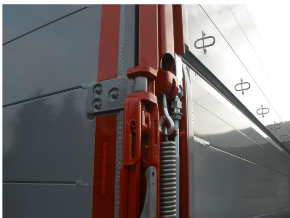
Kihajtható hátsó ajtó: minden mozgó alkatrész (zsanér, zár, csap, csapszeg) működésének és kopottságának ellenőrzése
