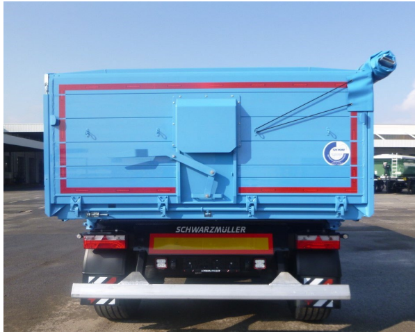
Hátsó ajtó: hegesztési varratok ellenőrzése, van-e repedés
