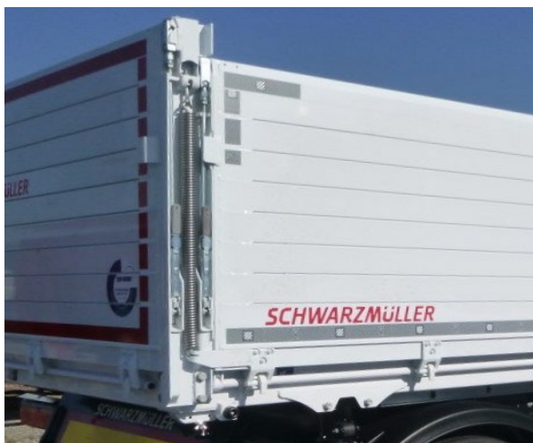
Kihajtható hátsó ajtó: minden mozgó alkatrész (zsanér, zár, csap, csapszeg) működésének és kopottságának ellenőrzése
