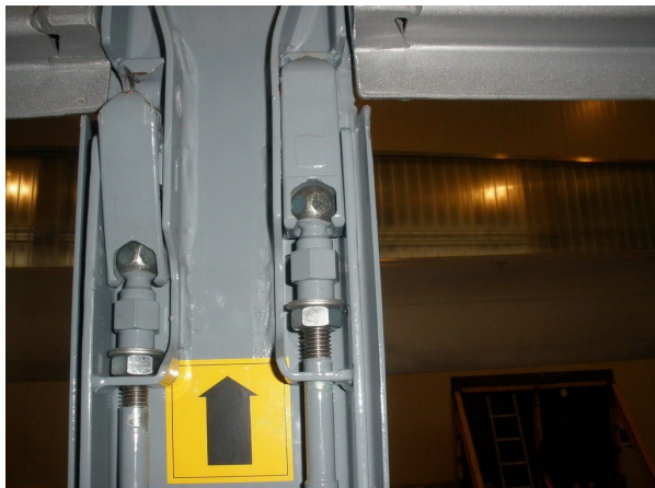
Zárszerkezet: lengőcsapszeg holtjátékának és működésének ellenőrzése
