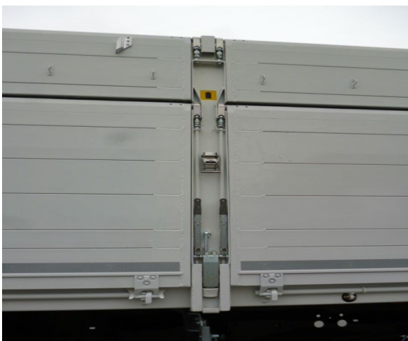
Mellfal, középoszlop(ok) és hátsó oszlopok: zárszerkezet működésének ellenőrzése
