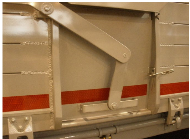
Hátsó ajtó: hegesztési varratok ellenőrzése, van-e repedés
