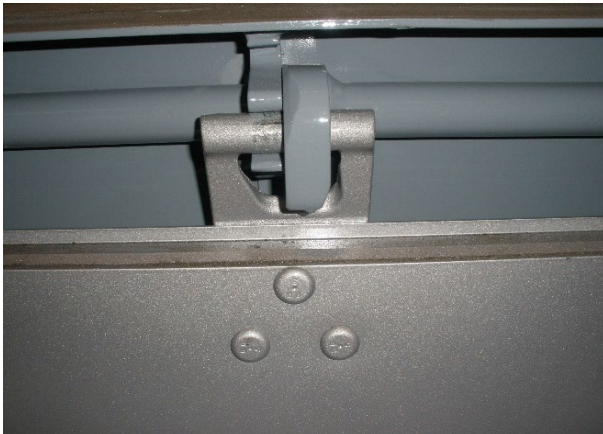
Központi zár: szemrevételezéses vizsgálat elhasználódásra, holtjáték stb.
