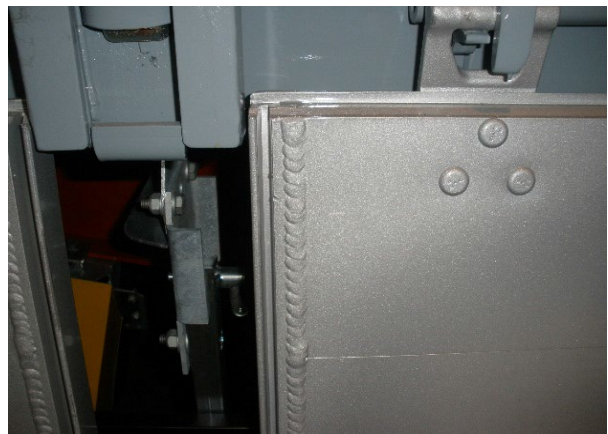
Oldalajtó: hegesztési varratok ellenőrzése, van-e repedés
