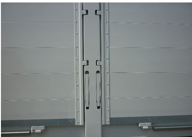
Középoszlopok és sarokoszlopok elöl és hátul: a zárszerkezet megfelelő működésének ellenőrzése
