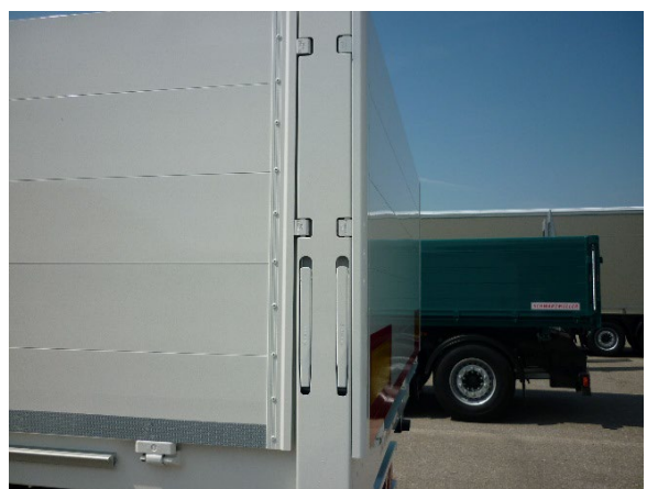
Középoszlopok és sarokoszlopok elöl és hátul: a zárszerkezet megfelelő működésének ellenőrzése
