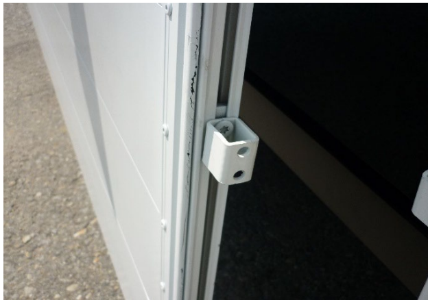
Zár ellendarabok megfelelő rögzítettsége, ill. van-e rajta sérülés
