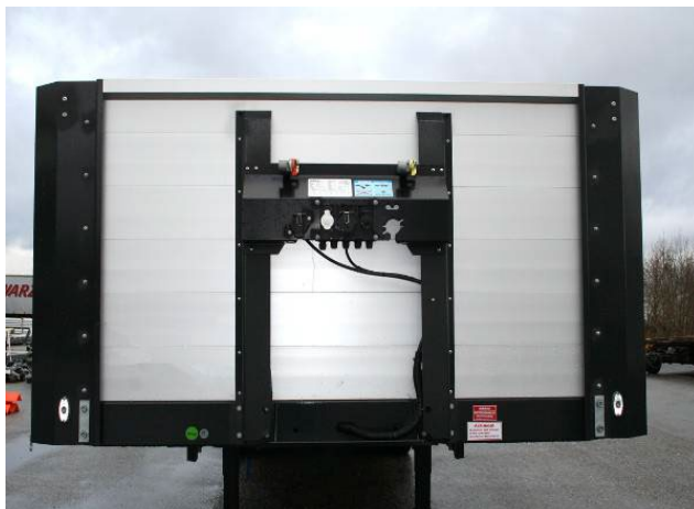
Ellenőrizni kell a szegecsek és csavarok rögzítettségét
