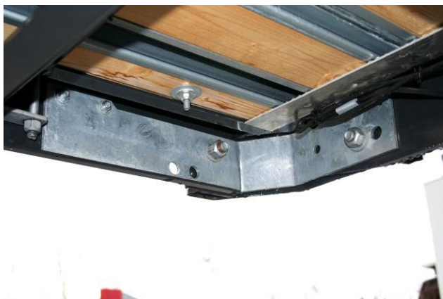
Sarokoszlopok rögzítőcsavarjait belül ellenőrizni
