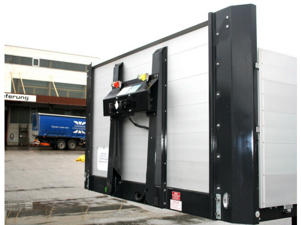
Készülékartató: szegecsek és csavarok rögzítettsége
