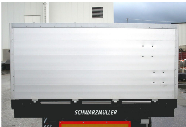
Hátsó ajtó: szegecsek rögzítettségének ellenőrzése
