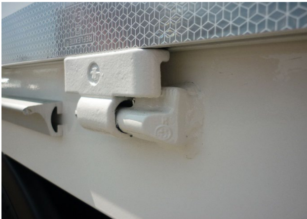
Zsanérok megfelelő működésének ellenőrzése, ill. van-e rajtuk sérülés. A zsanércsap hegesztési varratainál ellenőrizni kell, van-e rajta repedés
