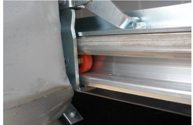
Alsó csuklók és futókocsik működését, kopottságukat ellenőrizni, csavarok rögzítettségét ellenőrizni
