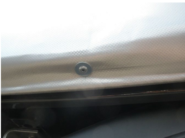
Alsó ponyvarögzítő szegecsek rögzítettségét ellenőrizni
