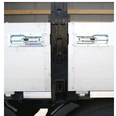
Oldalajtó: zárszerkezet és szegecsek megfelelő rögzítettsége
