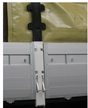
Oldalajtó: zárszerkezet és szegecsek megfelelő rögzítettsége
