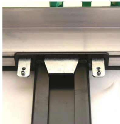
Középoszlopok futókocsija: szegecsek megfelelő rögzítettsége
