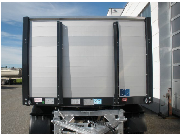
Ellenőrizni kell a szegecsek és csavarok rögzítettségét
