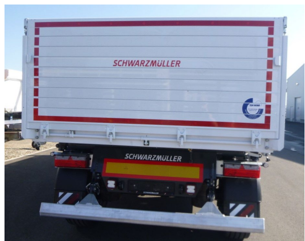
Zadní stěna: zkontrolovat svary na praskliny.
