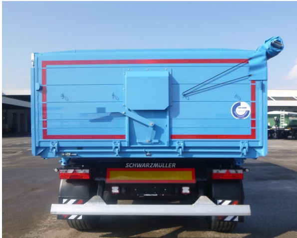
Zadní stěna: zkontrolovat svary na praskliny.
