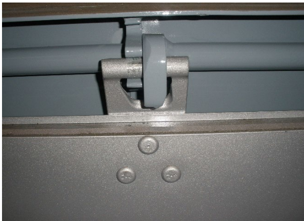
Centrální uzavírání: vizuální kontrola opotřebení, vůle atd.
