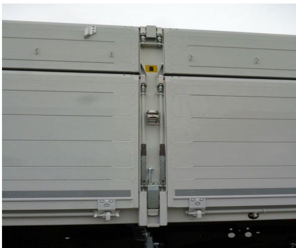
Přední stěna, středový sloupek a rohové sloupky vzadu: zkontrolovat funkčnost zavírání a zámků.
