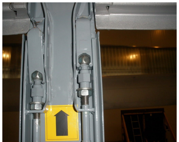
Přední stěna, středový sloupek a rohové sloupky vzadu: zkontrolovat funkčnost zavírání a zámků.
