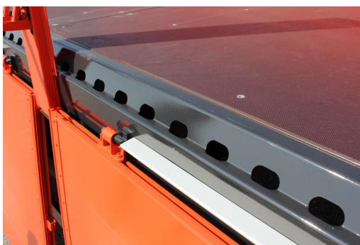
Nejrůznější provedení děrovaného vnějšího rámu.
