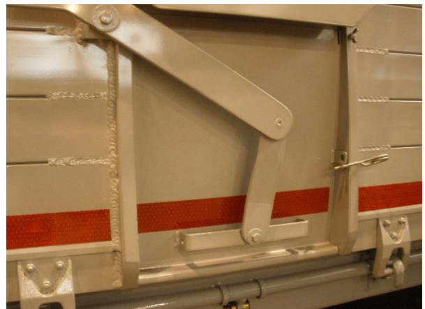
Zadní stěna: zkontrolovat svary na praskliny.
