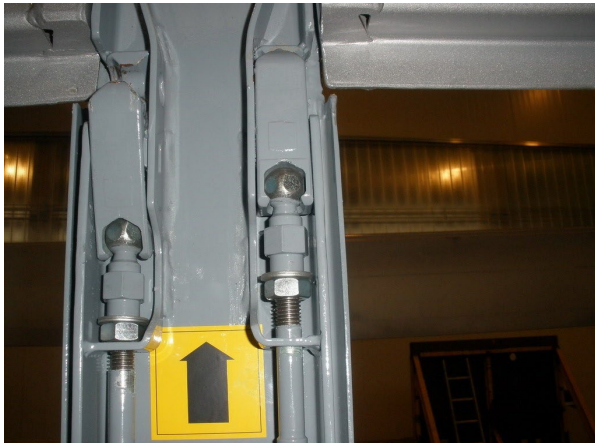
Zkontrolovat funkčnost a vůli čepů/ zavírání.
