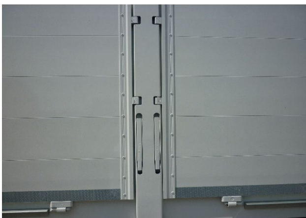
Středové a rohové sloupky (vpředu a vzadu): zkontrolovat řádnou funkčnost zavírání.
