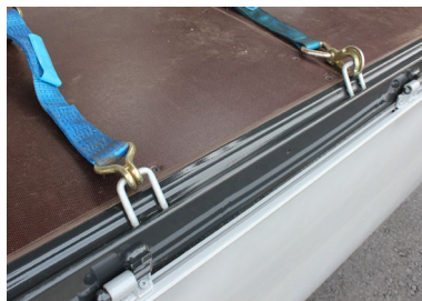
Nejrůznější provedení upínacích třeňů po stranách podlahy.
