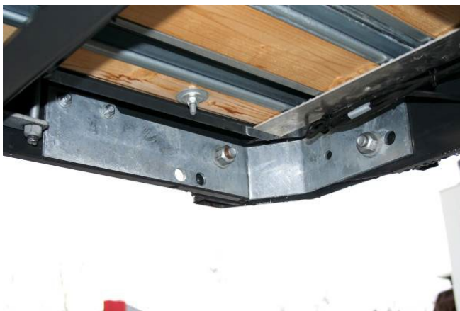
Zkontrolovat upevnění rohových sloupků zevnitř.
