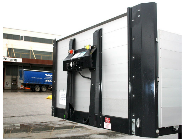
Držák přípojů: zkontrolovat upevnění nýtů a šroubů.
