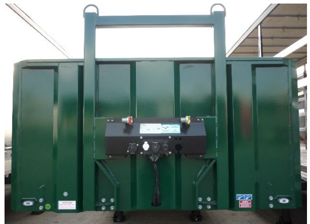
Zkontrolovat upevnění šroubů a zkontrolovat svary na praskliny.
