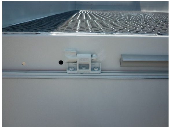
Závěsy: zkontrolovat řádnou funkčnost a stav opotřebení. Uchycení závěsů: zkontrolovat svary na praskliny.
