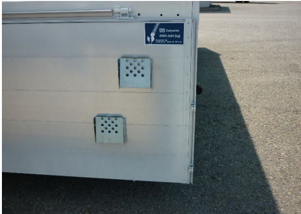
Zadní stěna: zkontrolovat upevnění nýtů.
