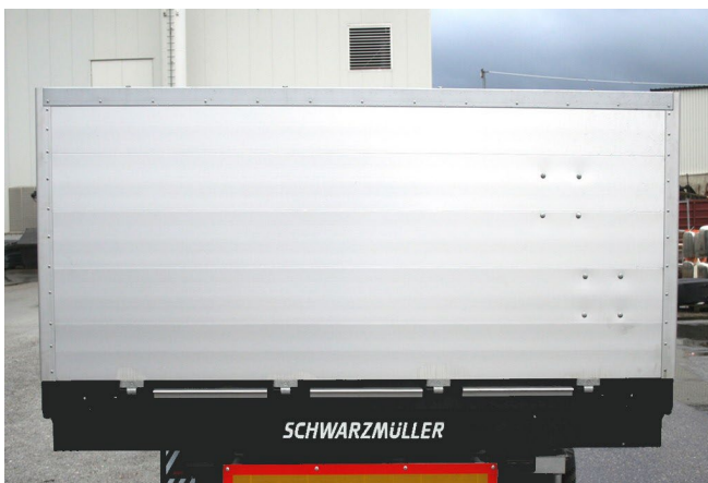
Zadní stěna: zkontrolovat upevnění nýtů.
