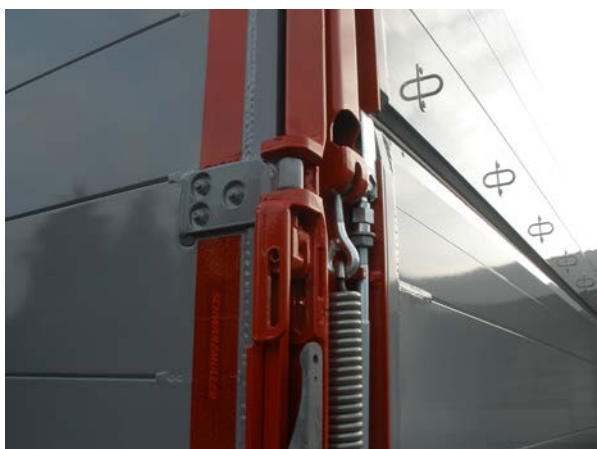
Rückwand zusätzlich schwenkbar: Alle beweglichen Anbauteile wie Scharniere, Verschlüsse, Bolzen, Zapfen etc. auf Verschleiß und Funktion prüfen
