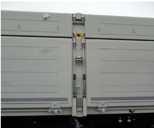
Vorderwand, Mittelsäule(n) und Ecksäulen hinten: Funktion der Verriegelung prüfen
