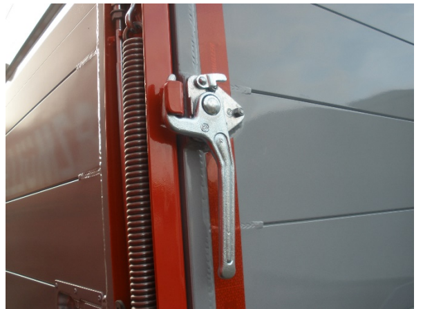
Verschluss: Auf Verschleiß und Funktion prüfen
