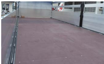
Verschiedenste Ausführungen von Zurrbügeln seitlich am Plateau
