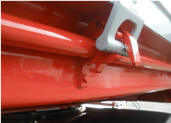
Zentralverriegelung: Sichtprüfung auf Abnutzung, Spiel, Verschraubung etc.
