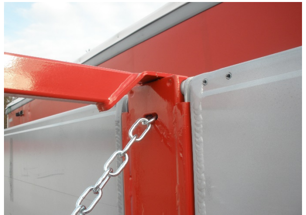
Mittellungenverbindung bzw. Kettenverbindung: Sichtprüfung Allgemeinzustand
