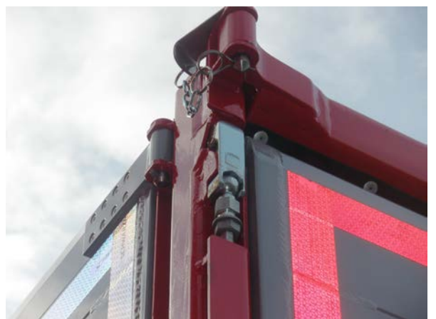
Rückwand zusätzlich schwenkbar: Alle beweglichen Anbauteile wie Scharniere, Verschlüsse, Bolzen, Zapfen etc. auf Verschleiß und Funktion prüfen
