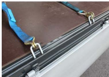
Verschiedenste Ausführungen von Zurrbügeln seitlich am Plateau
