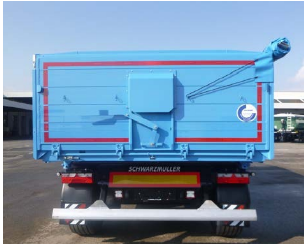
Rückwand: Schweißnähte auf Risse prüfen
