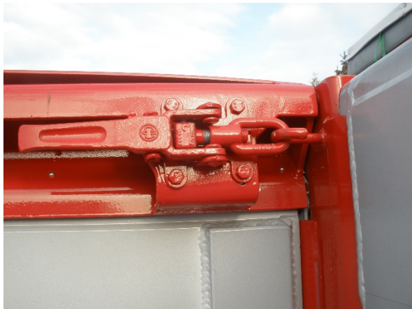
Verriegelung oberer Querbalken der Rückwand: Auf Festigkeit und Funktion prüfen
