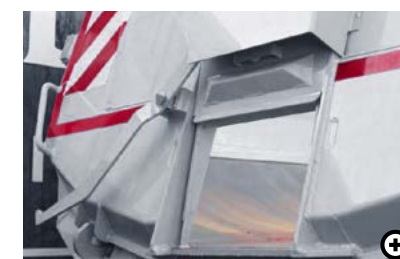
J Zasuwa do asfaltu (plus wtyczka zabezpieczająca do blokady) Dodatkowy, mały otwór w tylnej klapie umożliwia precyzyjny rozładunek asfaltu.
