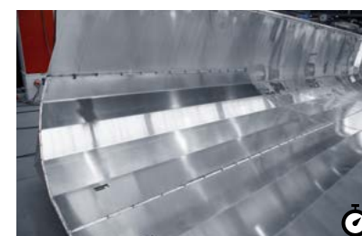
E Mulda aluminiowa Wywrotka w całości wykonana z aluminium. Waży ok. 900 kg mniej niż wywrotka ze stali.
