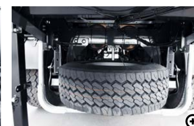
T Uchwyt koła zapasowego Umożliwia bezproblemowe przewożenie koła zapasowego.
