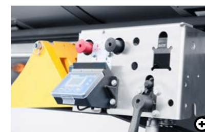
D Pulpit sterujący Umieszczenie w jednym miejscu elementów sterujących, np. zaworów do luzowania hamulców, urządzenia do podnoszenia i opuszczania, modułów kontroli naczepy oraz blokady obniżenia, aby ułatwić obsługę pojazdu.
