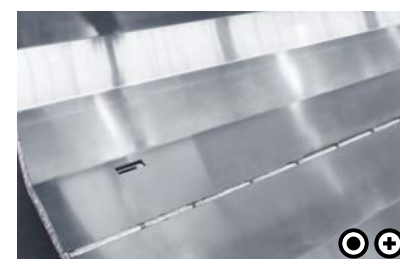
F Trudnościeralna podłoga (wersja z aluminium lub stali) Blacha aluminiowa znajdująca się w tylnej części pojazdu chroni muldę przed zbyt wczesnym zużyciem. W przypadku ciężkich i abrazyjnych sypkich materiałów zaleca się stosowanie dodatkowej trudnościeralnej podłogi z blachy Hardox o gr. 3 mm.
