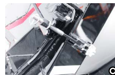
L Śruby mocujące Gęsty, płynny materiał zwiększa nacisk na tylną kłapę. Aby kłapa wytrzymała takie obciążenie, jako zabezpieczenie montowane są dodatkowe śruby mocujące.
