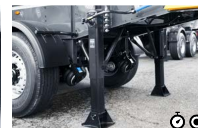
W Podpory Firma Schwarzmüller oferuje różnego rodzaju podpory: w wersji korbowej ze stali lub aluminium albo w wersji składanej ze stali lub aluminium.
