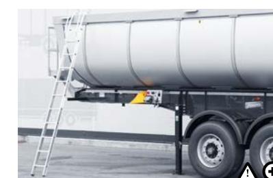
S Drabinka Specjalny kształt drabinki umożliwia bezpieczne wchodzenie i schodzenie z muldy podczas wykonywania prac serwisowych i czyszczenia.
