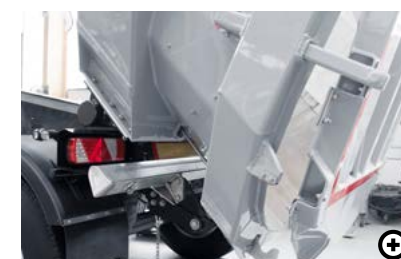
K Urządzenie dozujące Za pomocą uchwytu ograniczającego można zmniejszyć szerokość otwarcia tylnej klapy. Dzięki temu możliwy jest precyzyjny rozładunek sypkich materiałów.
