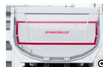
G Ściana tylna z rynną zsypową Ściana tylna osadzona jest w muldzie, tworząc rynną zsypową. Punkt ciężkości ładunku zostaje przesunięty do przodu, co zwiększa nacisk na tylną oś ciągnika.
