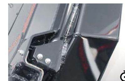
M Gumowa uszczelka Dodatkowe gumowe uszczelki w tylnej klapie gwarantują odpowiednią szczelność muldy.
