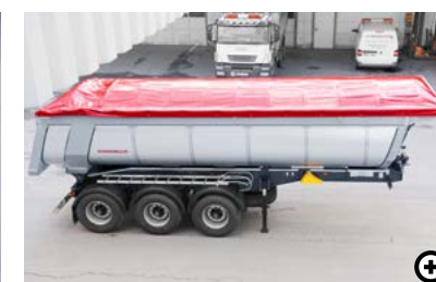
O Dach Schwarzmüller Elektrycznie przesuwany dach z pilotem do otwierania i zamykania ochronnej planeki bez konieczności wchodzenia na podest.
