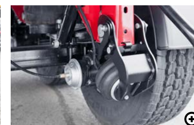
X Podnoszona oś Podnoszone osie zmniejszają zużycie opon. Podczas przejazdu pustych pojazdów, osie, które nie są w danej chwili potrzebne, są automatycznie podnoszone.
