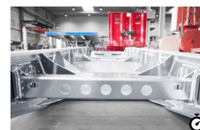
A Aluminiowa rama Opcjonalna rama aluminiowa zmniejsza masę pojazdu o 250 kg w porównaniu do wersji wykonanej ze stali.
