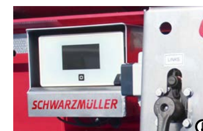
P Termomulda, pomiar temperatury w 5 punktach pomiarowych Czujniki kontrolują temperaturę ładunku w muldzie. W ten sposób można zagwarantować lepszą urabialność materiału. Parametry zapisywane są w urządzeniu do zapisu danych.
