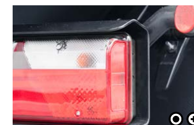
V Oslona światła Światło tylne posiada blaszaną osłonę chroniącą je w możliwie najlepszy sposób przed uszkodzeniem i większymi zabrudzeniami.
