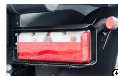
U Oświetlenie LED Światło tylne w wersji standardowej wykonane jest częściowo w technologii LED. Opcjonalne wyposażenie obejmuje wykonanie całej lampy w technologii ledowej.
