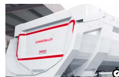
I Hydrauliczna kłapa w tylnej części pojazdu Kłapę można w całości otworzyć hydraulicznie. Dzięki temu otwarta jest cała przestrzeń, co umożliwiło bezproblemowy rozładunek nawet dużych kamieni.
