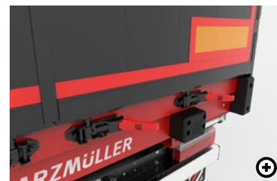
6 Blokada drzwi, obsługa jedną ręką
