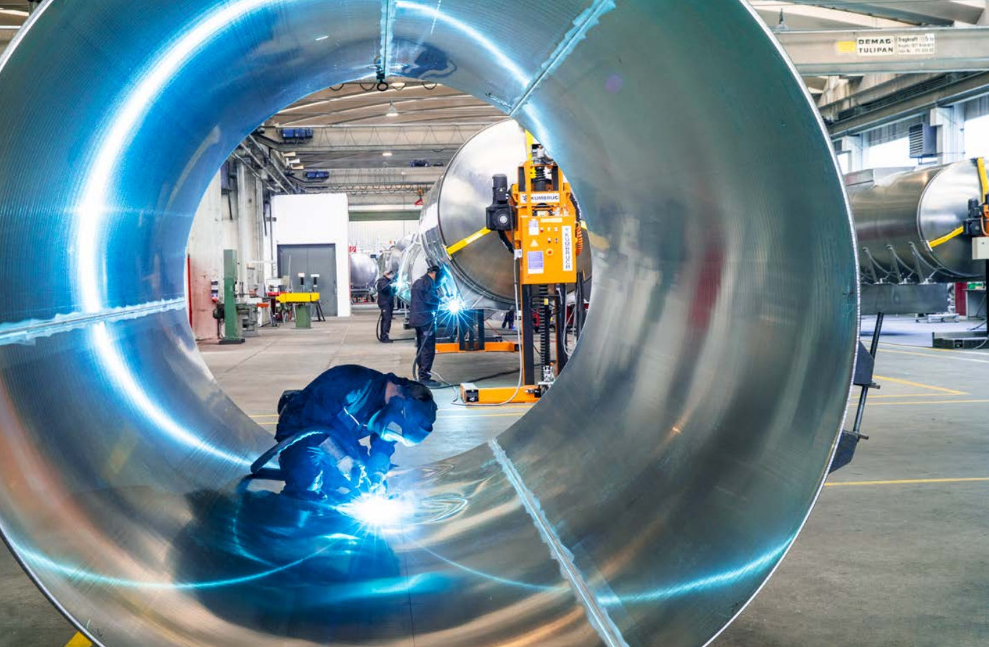
Tankfahrzeuge werden in aufwändiger Arbeit im Mutterwerk Hanzing gefertigt.
