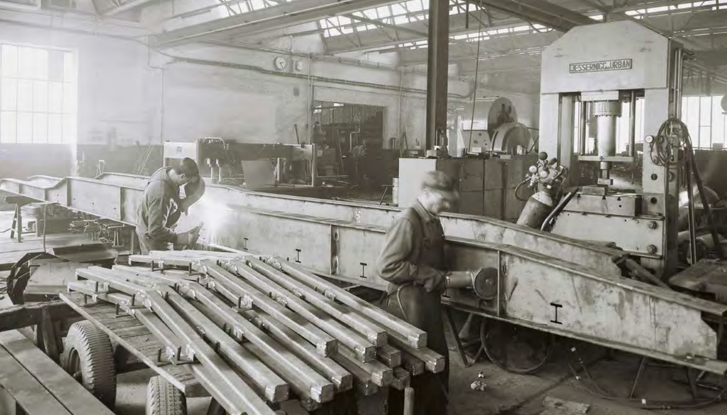
Fertigung von Längsträgern für die Fahrzeugrahmen am Hauptsitz Hanzing in der Nachkriegszeit. Der Rahmen als Herzstück eines Nutzfahrzeuges ist bis in die Gegenwart eine der Kernkompetenzen von Schwarzmüller.
