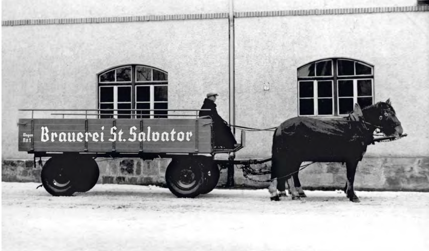
Pferdegezogenes Fuhrwerk aus dem Jahr 1925 für die Brauerei St. Salvator bei Griesbach im Rottal mit den technischen Neuerungen Drehsattel, Stahlfelgen und Luftreifen.
