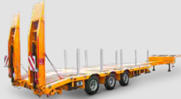
3-Achs-Tiefladesattel mit Kröpfung und teleskopierbarem Rahmen
