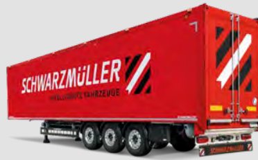
3-Achs-Schubboden-Sattelanhängers mit Aluminiumrahmen
