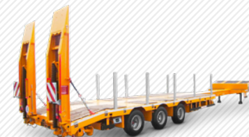
3-Achs-Tiefladesattel mit Kröpfung und teleskopierbarem Rahmen. Ausziehlänge bis zu 6 m.
