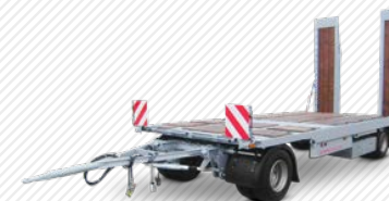
2-Achs-Tiefladeanhänger mit Auffahrampen und geradem Plateau. Variante: gekröpftes Plateau
