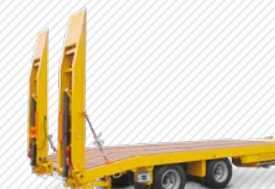
Zentralachs oder Tandem Tiefladeanhänger mit Auffahrampen. Variante: 3-Achser
