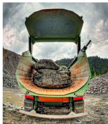
Auch für echte Brocken. Die Schwergesteinsmulde bietet großzügigen Durchlass.
