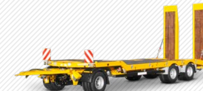
3-Achs-Tiefladeanhänger mit Auffahrampen und gekröpftem Plateau. Variante: gerades Plateau
