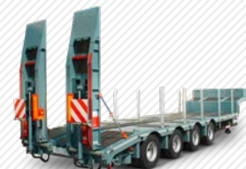
4-Achs-Tiefladesattel mit Auffahrampen. Varianten: 2-, 3-, 4-, 5-Achser
