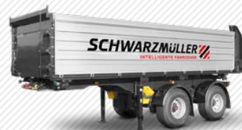
2-Achs-3-Seiten-Kippsattel mit großem Radstand und 2 x 10 t Achsen. Varianten: 2 x 9 t Achsen und kurzer Radstand, 3-Achs-3-Seiten-Kippsattel
