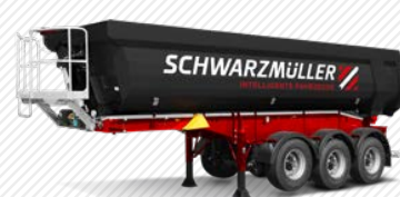
3-Achs-Segmentmulden-Kippsattel. Fahrgestell: Alu oder Stahl. Kippmulde: Alu oder Stahl. Variante: 2-Achser
