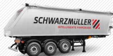
3-Achs-Alu-Kastenmulde. Optional mit Alu- oder Stahl Fahrgestell. Variante: 2-Achser
