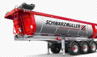
3-Achs-Thermo-Segmentmulde. Fahrgestell: Alu oder Stahl. Kippmulde: Alu oder Stahl. Variante: 2-Achser
