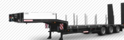
3-Achs-Tiefladesattel mit Auffahrampen. Varianten: 2-, 3-, 4-, 5-Achser
