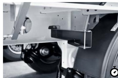
H Lattenhalterung Nicht benötigte seitliche Latten können in der speziellen Halterung sicher und bequem verstaut werden.
