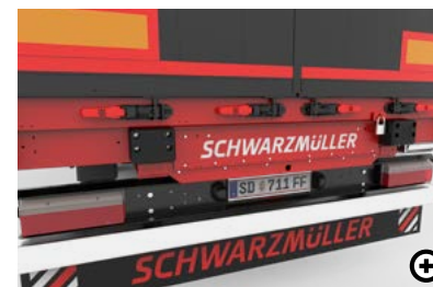
Z Staufach Zwischen den Rahmenlängsträgern am Ende des Fahrzeuges kann ein zusätzliches Staufach integriert werden.
