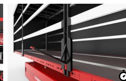
19 Verschiebbare Säulen Das einfache und schnelle Verschieben der Mittelsäule zur Seite hin eröffnet die volle Einladebreite.
