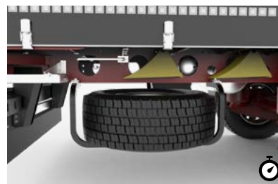
N Reserveradhalter So kann ein Reserverad sicher und bequem mitgeführt werden.
