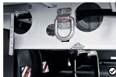
K Schiffsbinderunge Diese Sicherungselemente des Sattelanhängers sind für den Transport auf einer Fähre notwendig.
