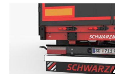
18 Rammschutzpuffer Diese Gummipuffer schützen vor Beschädigungen beim Anfahren an Rampen.
