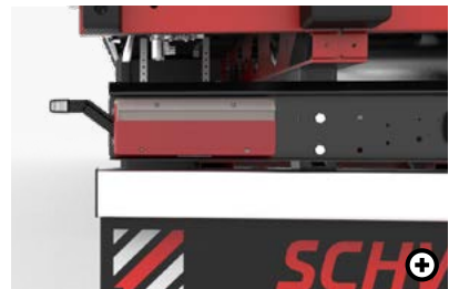
F LED-Beleuchtung Vollständige Bestückung mit LED-Leuchtkörpern. Für die automatische Fehlererkennung wird ein Vorschaltgerät montiert.
