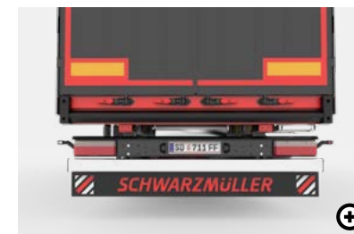
X Gummi-Delta Kann als Rammschutz beim Anfahren an Rampen angebaut werden.
