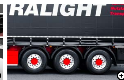
16 Einzelradkotflügel Reduziert das Versprühen von Wasser durch die Reifendrehung bei nasser Fahrbahn und schont dadurch die Bodenunterseite.
