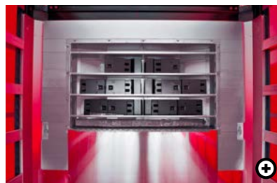
C3 Keilekasten (Papier) Sicherungskeile für den Papierrollen-transport sind in einem in der Vorderwand integrierten Kasten verstaut. Der Fahrer hat direkten Zugriff von der Ladefläche.
