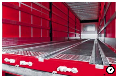
C2 Einlagen für Joloda Schienen Im General Cargo Einsatz werden die Schienen mit Kunststoff-Einlageprofilen abgedeckt bzw. aufgefüllt.
