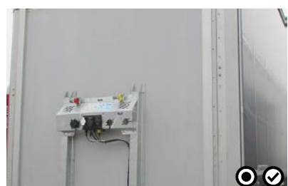
11 Stirnwand Die Vorderwand bringt eine zusätzliche Gewichtsersparnis von 60 kg und die enorme Robustheit erspart den zusätzlichen Vorderwandschutz auf der Innenseite.
