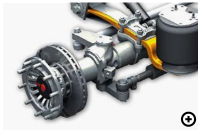
D Lenkachse Der Reifenverschleiß wird reduziert und die Wendigkeit des Sattelanhängers erhöht.
