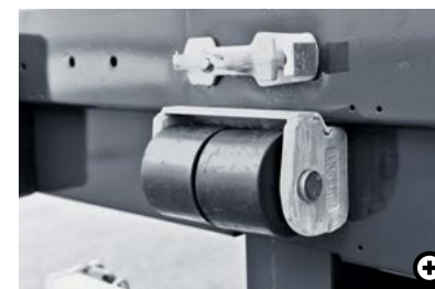
Y Butt-Roll Beim Anfahren der Rampen werden bewegliche Rammrollen eingesetzt. Die Rollen verhindern Schäden, die durch die Auf- und Abbewegungen bei der Beladung entstehen.
