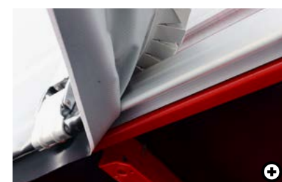
1 Planeneinhakleiste Ermöglicht die senkrechte Fixierung der Seitenplane am Außenrahmen. Gewährleistet einen sauberen Abschluss, auch ohne eine schräge Befestigung der Spanner.
