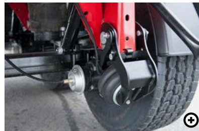
E Liftachse Reduziert den Reifenverschleiß. Kann kurzzeitig für die Erhöhung der Sattelzugmaschinen-traktion eingesetzt werden.
