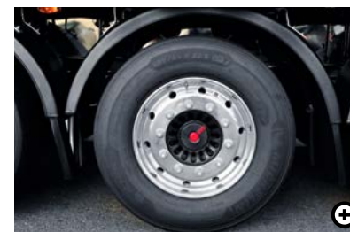
W Alu-Felgen Mit diesen Leichtbau-Felgen reduziert sich das Eigengewicht des Fahrzeuges um weitere 120 kg.
