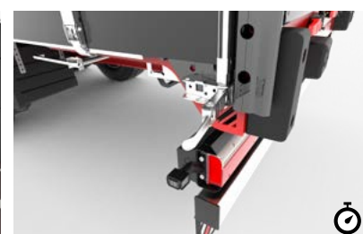
20 Spannratsche Erlaubt ein schnelles Spannen der seitlichen Planen. Sie sind in Fahrtrichtung links und rechts an der Rückseite angebracht.
