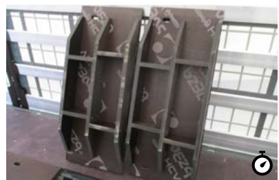
B2 Abdeckung für Coilmulde Im General Cargo Einsatz wird die Coilmulde abgedeckt.
