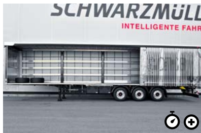
A Quick-Slider Mit diesem Öffnungssystem wird die Seitenplane in 5 sek. geöffnet oder geschlossen.
