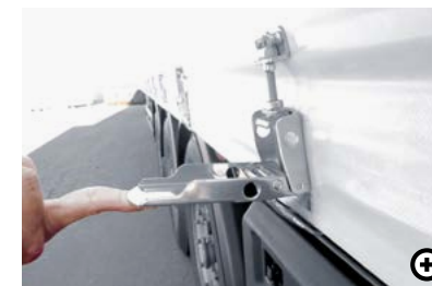
R Direktspanner Sind anstelle der Over Center Spanner erhältlich, bilden einen sauberen Abschluss zum Außenrahmen und sind schneller zu öffnen bzw. zu schließen.
