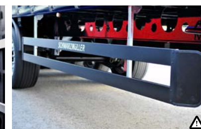
13 Seitenschutz Gesetzlich vorgeschriebener Radfahrerschutz, damit keine Personen vor die Räder fallen können.
