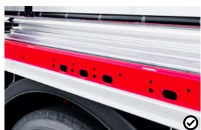
8 Lochaußenrahmen Zusätzlich zu den Zurrbügeln lassen sich am Lochaußenrahmen an jeder gewünschten Position Sicherungshaken für die Ladung anbringen.
