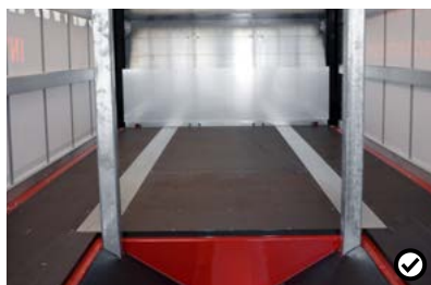
B3 Formrohrsteher für Coilmulde Diese Steher sichern die Coilmulde nach vorne und können an mehreren Stellen platziert werden. So werden die Rollen immer im Schwerpunkt transportiert.
