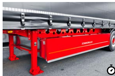
I Palettenkasten Wird unter dem Fahrgestellrahmen montiert. Diese ist bestens für den Transport von Leerpaletten geeignet und kann aber auch als Werkzeugkasten verwendet werden.
