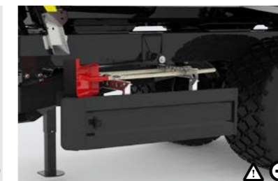
C Seitenschutz Der seitliche Anfahrerschutz erhöht die Sicherheit im Straßenverkehr (In vielen Ländern Vorschrift).
