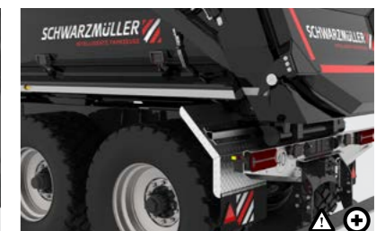
G Lichtpaket 2 Rückfahrcheinwerfer und 4 Arbeitsscheinwerfer seitlich sorgen für gute Rundumsicht.
