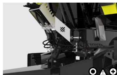
5 Hydraulische Deichselfederung Die 4 t Deichsel in V-Ausführung ist komfortabel mit hydraulischer Deichseldämpfung ausgeführt. Dies nimmt Schläge auf und gewährt ein angenehmes Fahrverhalten.
