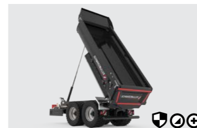
B Gesteinsmulde Die schwere Gesteinsmulde in 100% Hardoxausführung (HB450), Boden 8 mm, Seitenwand 6 mm, nimmt es mit größten Einsätzen auf.
