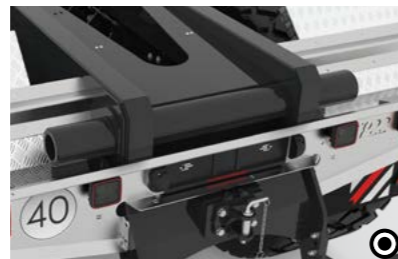
3 Einteilige Kipperwelle Die Kipperwelle wird nicht nur seitlich, sondern durchgehend angeschweißt. Durch diese Bauart erreicht man mehr Stabilität während des Kippvorgangs.
