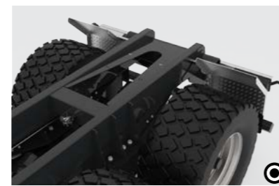
1 Torsionsblech Eine bewährte und durchdachte Lösung um im Heckbereich des Kippfahrzeugs optimale Stabilität während des gesamten Kippvorgangs zu gewährleisten.
