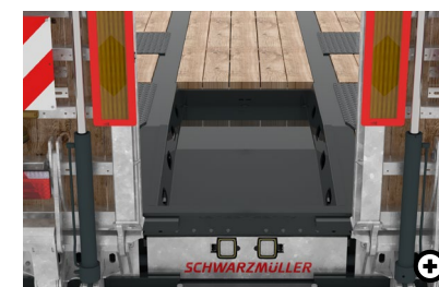
F Baggerstielmulde Die Baggerstielmulde ist eine Vertiefung in der Auffahrtschräge und dient zum Ablegen eines Baggerstiels.
