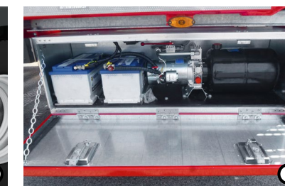
O Elektrohydraulisches Pumpenaggregat Zur Vermeidung einer externen hydraulischen Versorgung, wenn das Zugfahrzeug nicht mit Hydraulik ausgestattet ist.
