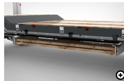
6 Staufach für Verbreiterungsbretter Die Holzauflagen für die Verbreiterung der Ladefläche befinden sich in einem Staufach unterhalb der Ladefläche.
