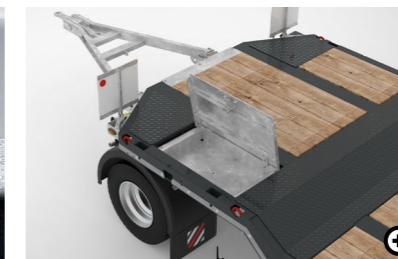
13 Staufach für Zubehör Das Staufach vorne im Plateau dient zum Mitführen von Zubehör und Werkzeugen.
