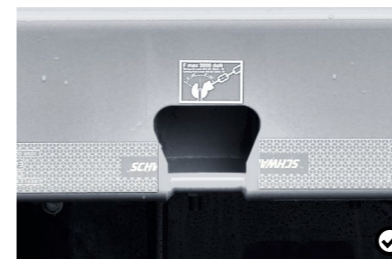
12 4 t Zurrstege Die Zurrstege dienen, wie die Zurringe, der Befestigung der Ladung.
