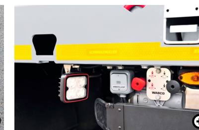
S Arbeitsscheinwerfer Die Arbeitsscheinwerfer sorgen für eine zusätzliche Beleuchtung während des Be- und Entladevorganges.
