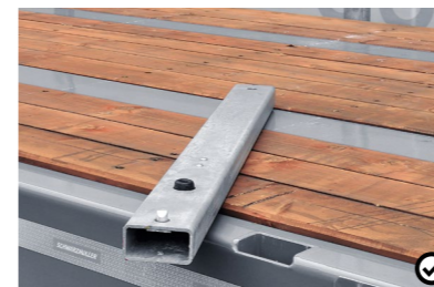
9 Taschen für Formrohungen Die Taschen im Außenrahmen können Formrohungen aufnehmen.
