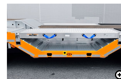
K Radmulden mit Abdeckungen Ermöglichen den Transport von hohen Baufahrzeugen, ohne die gesetzliche Gesamtfahrzeughöhe zu überschreiten. Können mit Abdeckungen begradigt werden.
