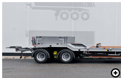
1 Gekröpftes Plateau Es bewirkt, dass im Tiefbett die Ladehöhe sehr niedrig ist. Dadurch können auch höhere Fahrzeuge transportiert werden.
