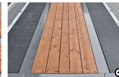
10 Douglasienboden Die Ladefläche ist mit Douglasienboden ausgestattet. Optional ist auch ein Hartholzboden möglich.
