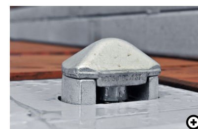
L Ausfahrbare Twistlock-Containerverriegelungen Die Twistlocks sind in der Ladefläche versenkt und garantieren einen sicheren Transport von Containern.
