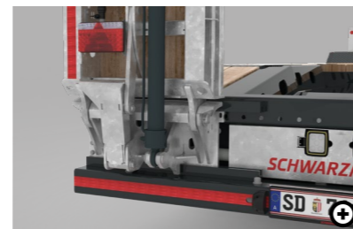
3 Seitlich verschiebbare Rampen Beide Rampen lassen sich manuell seitlich verschieben. Fahrzeuge mit unterschiedlichen Spurweiten können so problemlos beladen werden.
