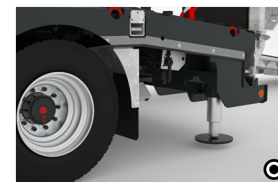
E Hydraulische Stützfüße am Fahrzeugende Die hydraulischen Stützfüße am Fahrzeugende verleihen zusätzliche Stabilität beim Beladen. Sie verhindern, dass der Anhänger vorne nach oben schnellt.
