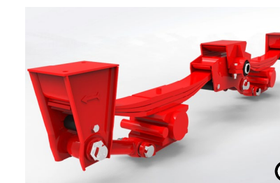
Q Parabelfederung Die Federung des Anhängers erfolgt über eine Blattfeder.
