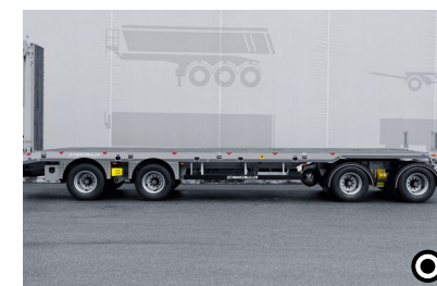
A Gerades Plateau Beim geraden Plateau ist die Ladefläche in einer waagrecht Ebene ausgeführt.
