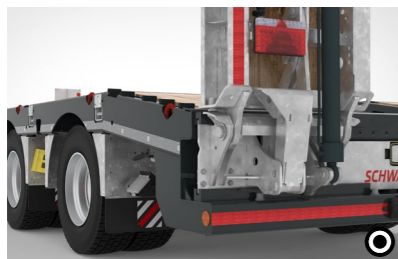
4 Klappstützen an den Rampen Bei der Rampenöffnung fahren die Klappstützen automatisch aus. Sie verhindern, dass beim Beladevorgang der Anhänger vorne nach oben schnell.
