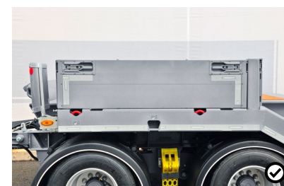
G Bordwände Die Bordwände dienen als zusätzliche Ladungssicherung beim Transport von Rüstzeug.
