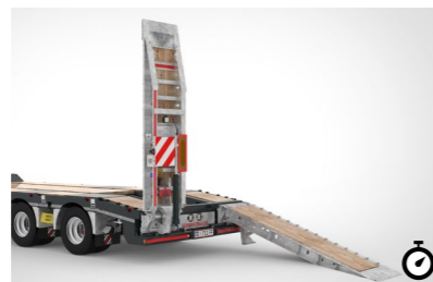
2 Klappbare 1-teilige Auffahrrampe Die klappbare einteilige Auffahrrampe wird zum Auffahren auf die Ladefläche nach unten geklappt.
