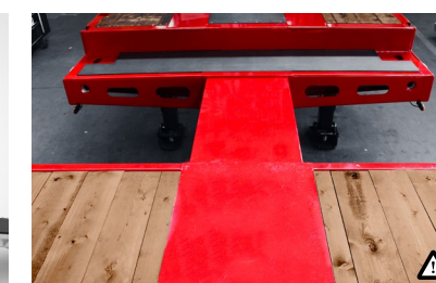
Y Ausziehbarer Zentralrahmen Ist zur Verlängerung der Ladefläche, um auch lange, sperrige Teile transportieren zu können.
