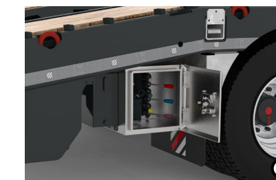
N Edelstahlkasten für Rampensteuerung Die Steuerung dient dem Anheben und Absenken der Auffahrampen. Optional auch für das seitliche Verschieben der Rampen verfügbar.
