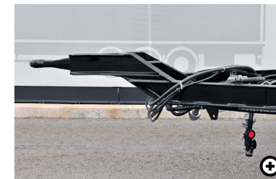
C1 Gekrüpfte Zuggabel Die gekrüpfte Zuggabel dient zum Ausgleich der Kupplungshöhe von LKW und Anhänger.
