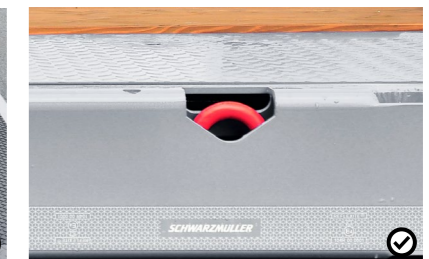
11 10 t Zurringe Die ausklappbaren Zurringe dienen zur Ladungssicherung des Transportgutes.
