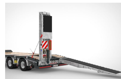
B Klappbare 2-teilige Auffahrrampe Sie wird zum Befahren der Ladefläche nach unten gekippt. Der niedrige Böschungswinkel ermöglicht eine problemlose Beladung von Fahrzeugen mit geringerer Bodenfreiheit.
