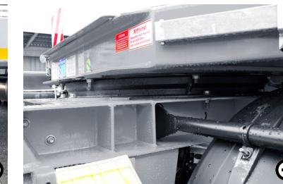
U Wartungsarmer Kugellenkranz Der wartungsarme Kugellenkranz reduziert die Schmierintervalle beim Drehkranz.
