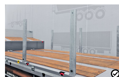
J Formrohre Die optional verfügbaren Formrohre können in den dafür vorgesehenen Taschen untergebracht werden.
