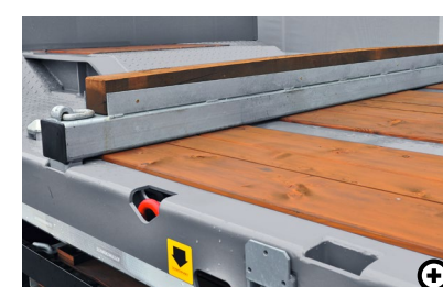
I Steckbare Querauflagen Die steckbaren Querauflagen unterstützen den Höhenausgleich bei gekrüpfte Ladefläche.
