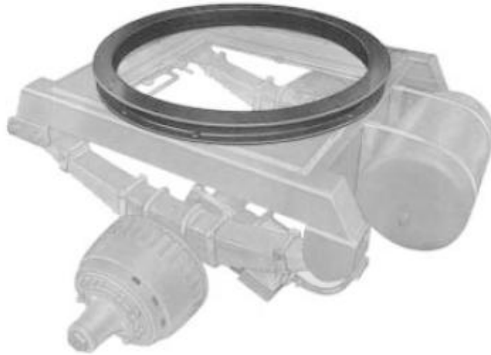
Bild 9 Drehgestell (grau) mit Lenkkranz
