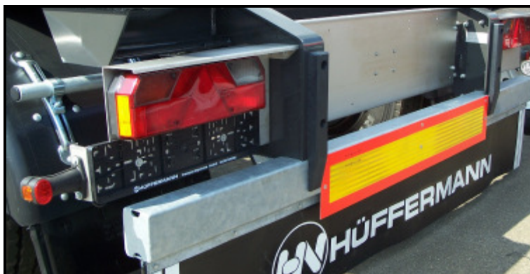
Bild 27 fester Unterfahrschutz HAR
