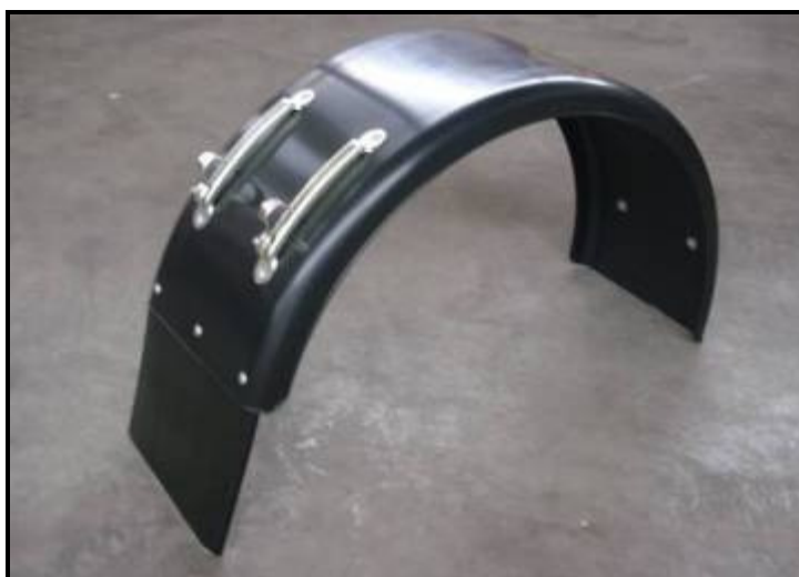
Bild 16 Kunststoffkotflügel mit Spritzschutz aus Kunststoff
